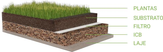
A laje deve estar devidamente impermeabilizada e protegida com tela anti-raízes.
